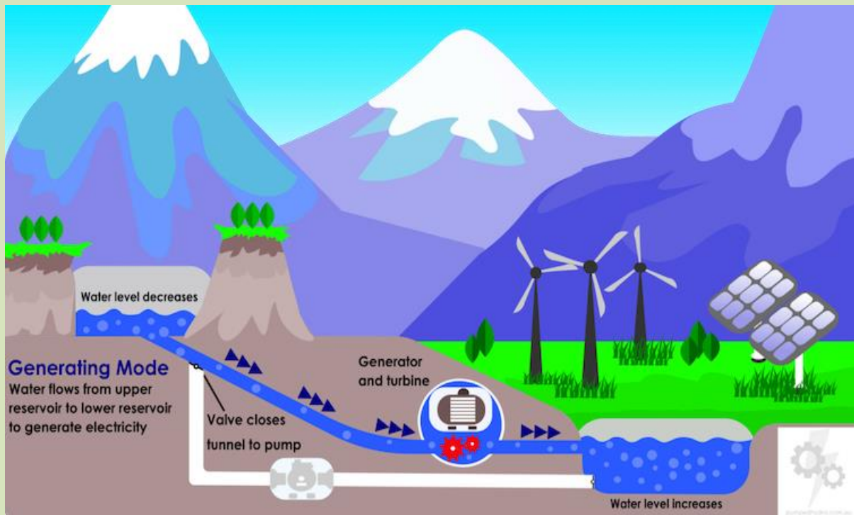
PLTA pumped storage pada mode pembangkit listrik. (sumber: pumpedhydro.com.au)
